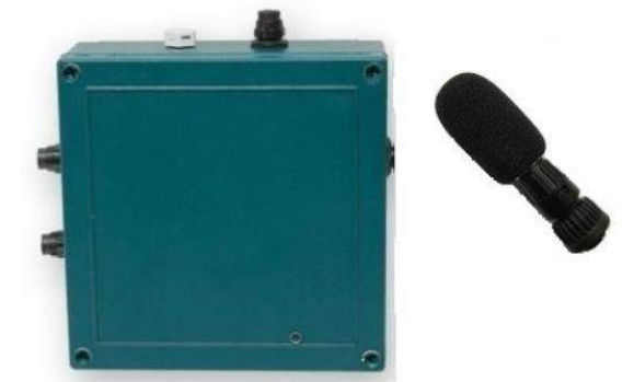
Figure 4 : Détecteur et enregistreur d'ultrasons SM2BAT+ Wildlife
