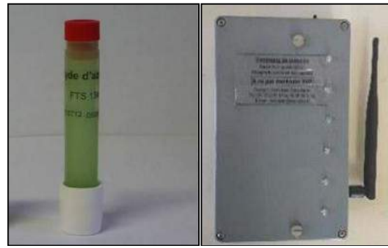
Figure 33 : Tube passif et micro-capteur laser
