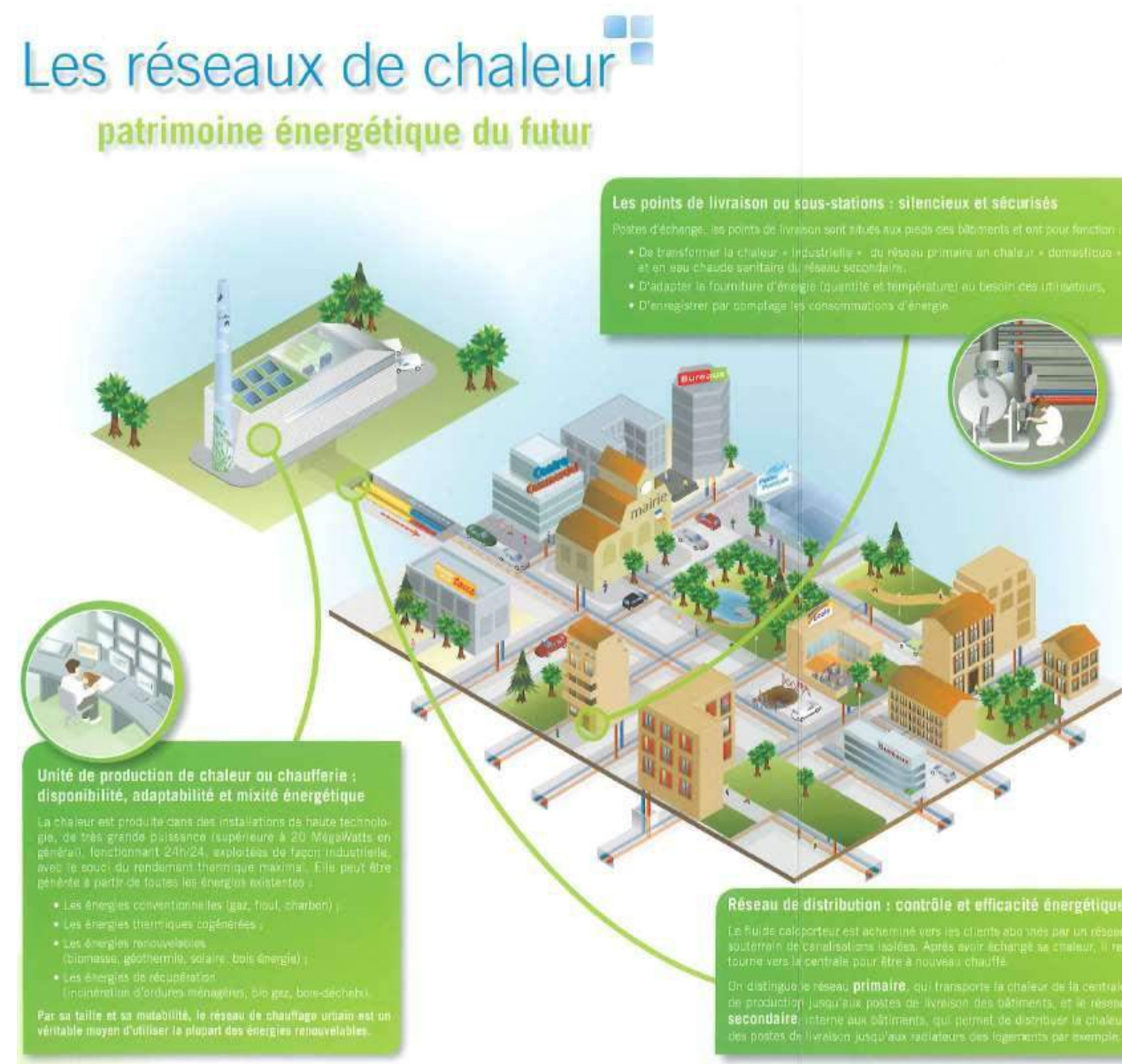
Figure 29 : Fonctionnement d'un réseau de chaleur en Ville.
